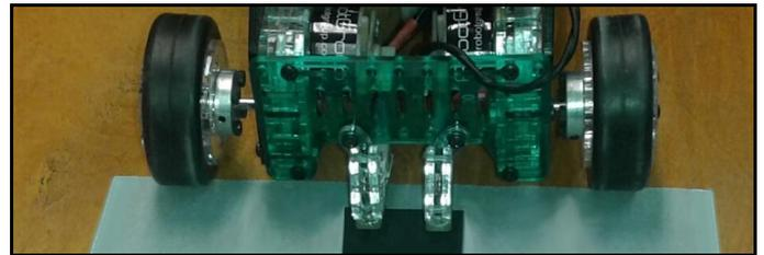
Fig. 2. Sensores frontales del Robot Multiplo N6
