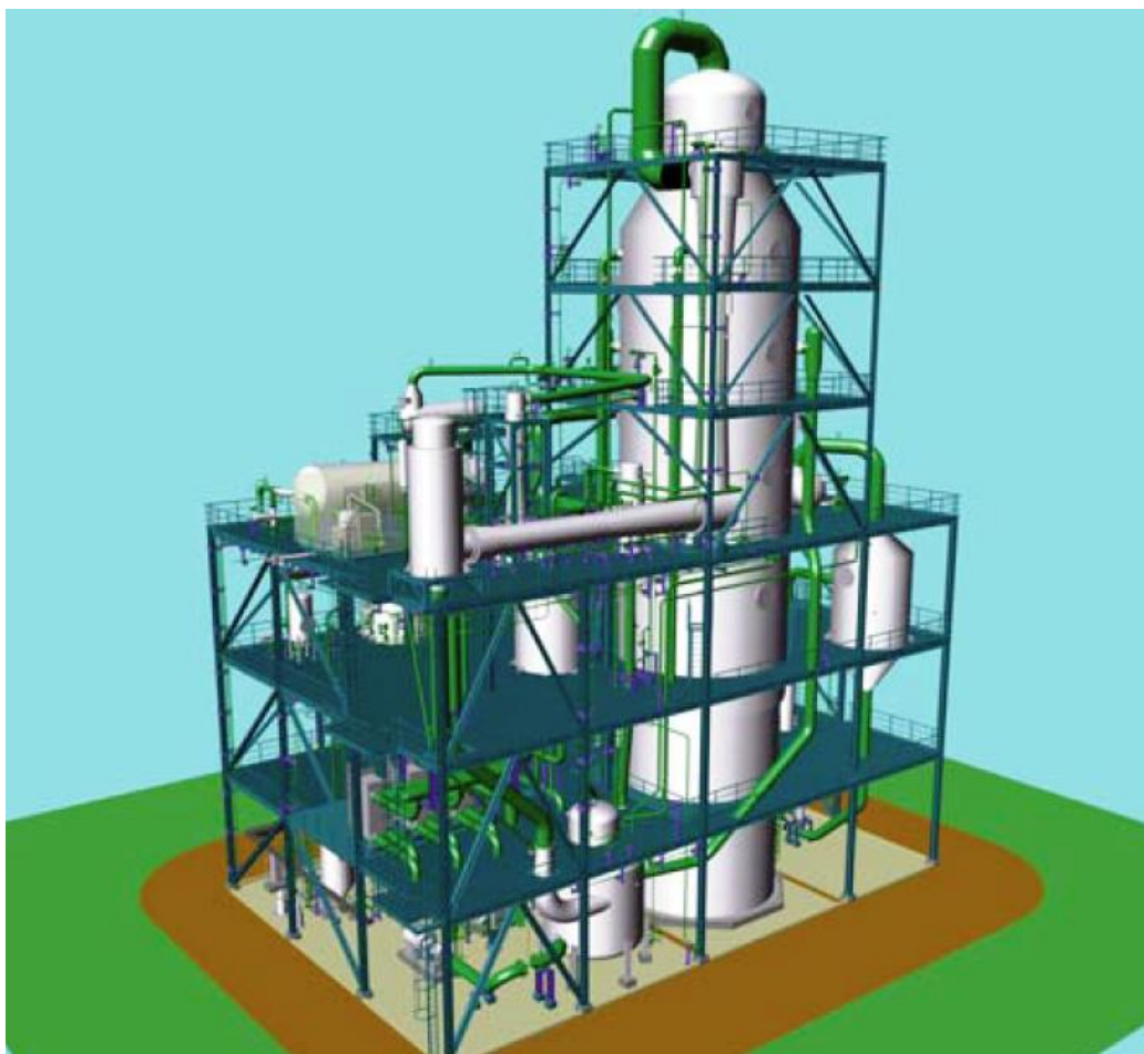
Fig. 87: Detalle de módulo de procesamiento de glicerina y distribución de equipos en plataforma.
