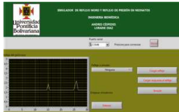
Fig. 3. Interfaz gráfica en LabView mostrando la señal del giróscopo.
