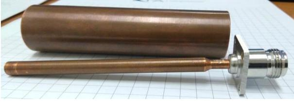
Fig. 5: Vista lateral de los conductores de la sonda.
