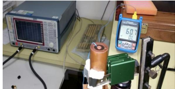
Fig. 3: Proceso de medición de  $S_{11}$  con VNA
