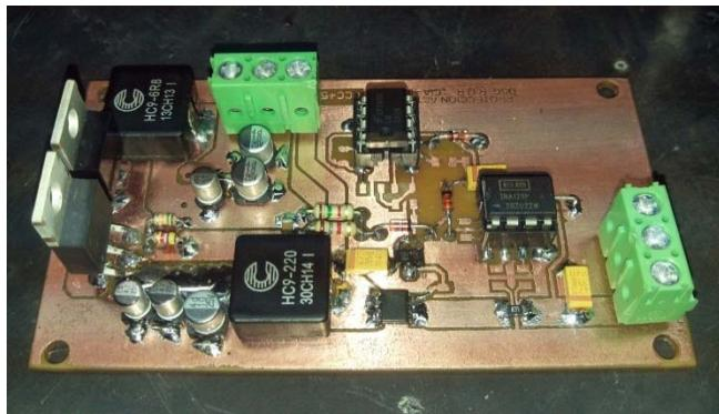
Figura 10. Implementación final del Circuito de Protección activa para un convertidor Buck LM2576 de Texas Instruments.
