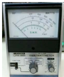
Figura 14: wattímetro con lectura de potencia indirecta
