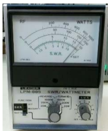
Figura 13: wattímetro con lectura de potencia directa
