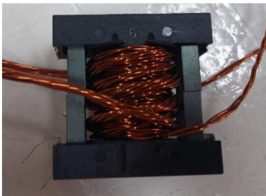
Figura 8: Fotografía del transformador HF.
