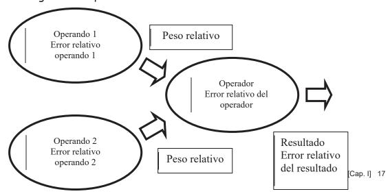
En el lugar de los operandos se coloca el nombre de los números (o los números) que intervienen en la operación; en el lugar del operador se coloca el símbolo correspondiente +; -;  $\times$  o %; en peso relativo los coeficientes de ponderación mencionados al analizar la propagación del error relativo y un error  $\varepsilon_+$ ;  $\varepsilon_-$ ;  $\varepsilon_+$ ;  $\varepsilon_-$ ;  $\varepsilon_+$  o  $\varepsilon_+$ .
