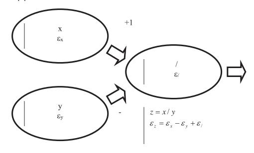
Combinando entre sí estos gráficos surge la secuencia de operaciones a realizar y se obtiene un medio apto para analizar el error relativo en el resultado.
