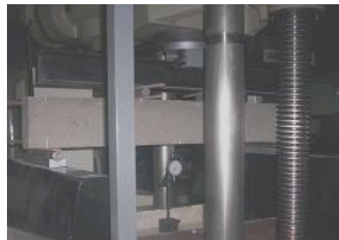
Figura 2: Ensayo a flexión: esquema de ensayo e instrumentación
