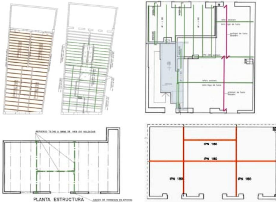
Figura 8. Refuerzos de los forjados, colocando vigas metálicas de parteluces para el apoyo de las viguetas de madera.
