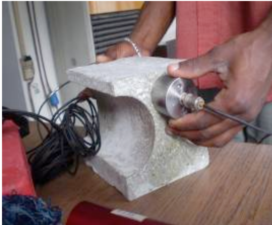
Gráfico 10. Hormigón vibrocompactado con peso volumétrico de 1\,770\text{ kg/m}^3 V_p = 3\,780\text{ m/seg.}
