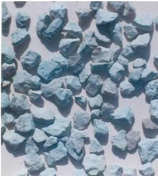
Gráfico 1. Zeolitas naturales trituradas. Fracciones 3/12,5 y 1/3 mm.
