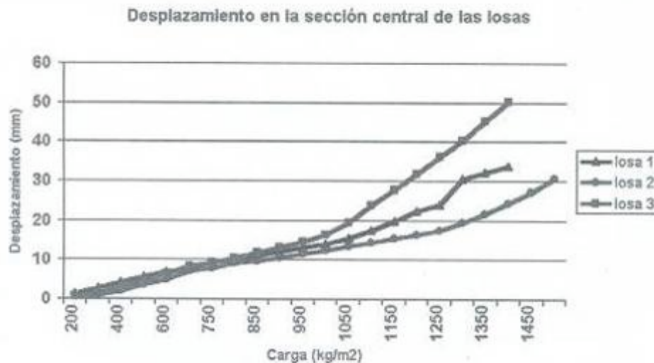
Gráfico 3. Comportamiento de los ensayos de carga–desplazamiento en losas.
