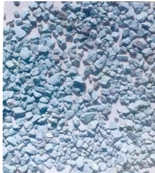
Gráfico 1. Zeolitas naturales trituradas. Fracciones 3/12,5 y 1/3 mm.
