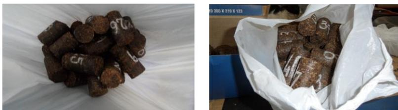
**Fotografía 11:** Producto final. Briqueta de 100 gramos y poder calorífico de 4.500 kilocalorías.
