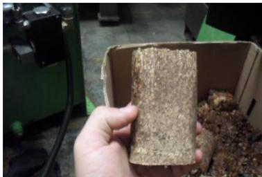
**Fotografía 9:** Puede notarse el cambio de tonalidad por el desprendimiento de humedad y aceite contenido en la materia prima.
