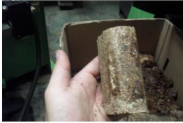
**Fotografía 8:** La compactación mejoró, se observa los restos de pepita de los ensayos anteriores.
