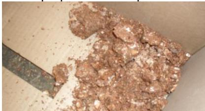
**Fotografía 2:** No alcanzaba a compactar. Puede observarse que ni bien caía la briqueta, se desintegraba.
