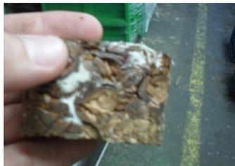
**Fotografía 3:** Con el aumento de presión, la consistencia es mayor que la briqueta anterior pero muestra fragilidad y el cambio de tonalidad debido a la existencia de pepita.
