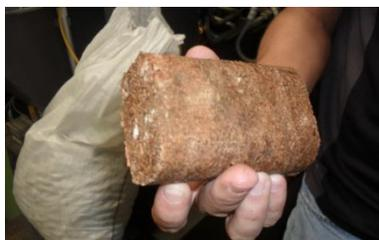
**Fotografía 6:** A simple vista, la briqueta es la ideal, pero aún sigue siendo frágil a causa fundamentalmente de la existencia de partículas de pepitas.
