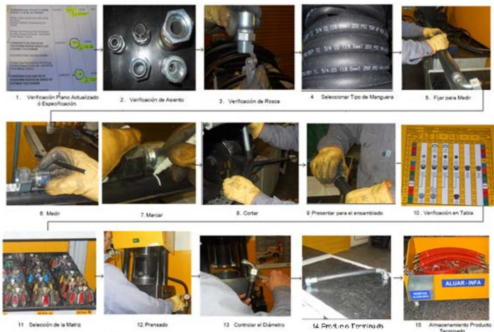
Figura 2 - Proceso de conexiones flexibles
