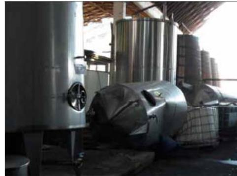
Figura 8 Daño depósitos de vino. Sismo de Chile en 2010.
