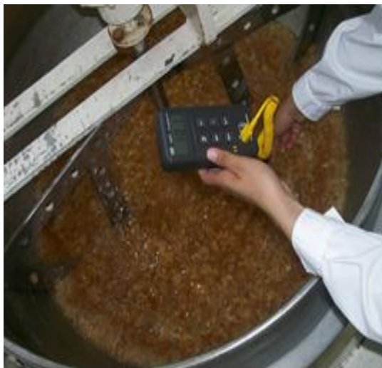
Figura 3 Medición de temperatura en la paila de cocción
