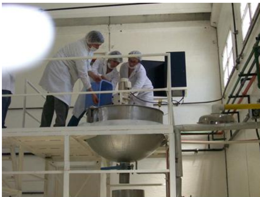
Figura 4 Carga de la paila de cocción con la pulpa, glucosa y azúcar.
