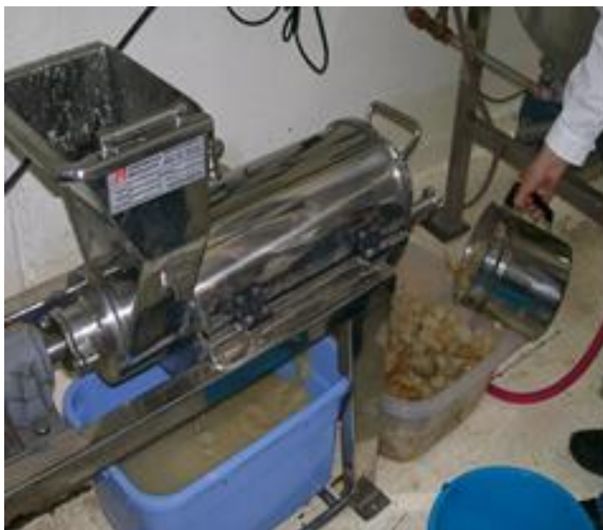
Figura 2 Aquí se ve la misma máquina de la figura 1, ahora procesando y separando pulpa de carozo.
