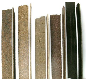
Figura 1 probetas obtenidas por extrusión bajo temperatura.
