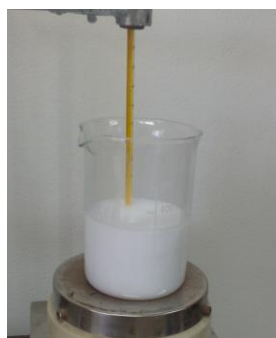
Figura 3 P123 disuelto en HCl en agitador magnético.
