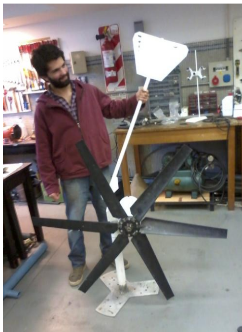
Figura 2 : vista del sistema de frenado furling
