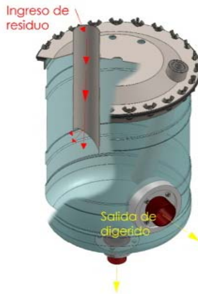
Figura 2 Alimentación y descarga de lodos.
