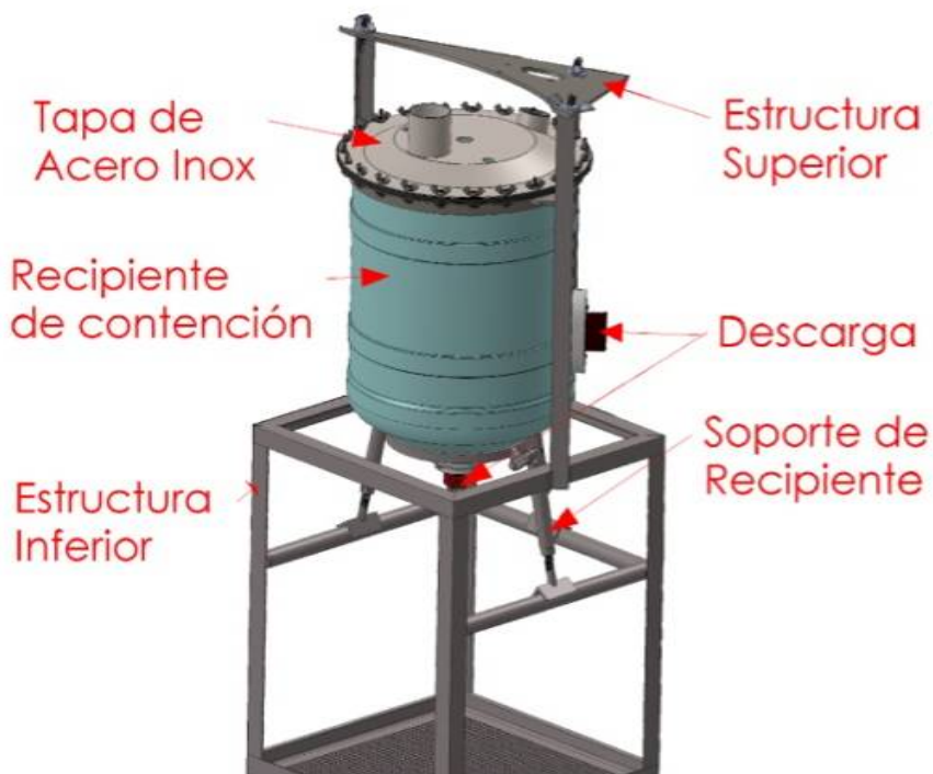
Figura 1 Sistema estructural de estanqueidad.
