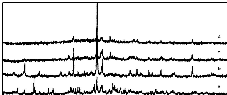
Figura 2. Difractogramas de rayos X comparadas para la muestra II residuo60-arcilla 40: a, cerámico commercial; b, probeta calcinada a 800°C; c, probeta calcinada a 900°C; d, probeta calcinada a 1000°C;
