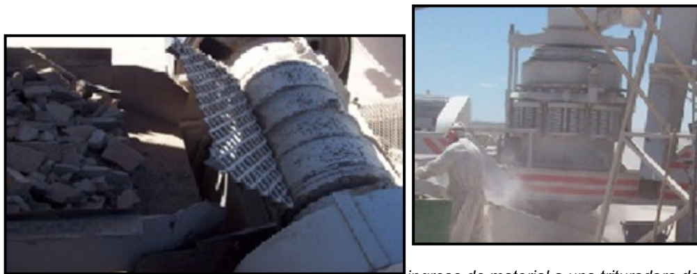
Figura 4. En la fotografía izquierda se observa el ingreso de material a una trituradora de mandíbula y en la fotografía de la derecha un cono de trituración.
