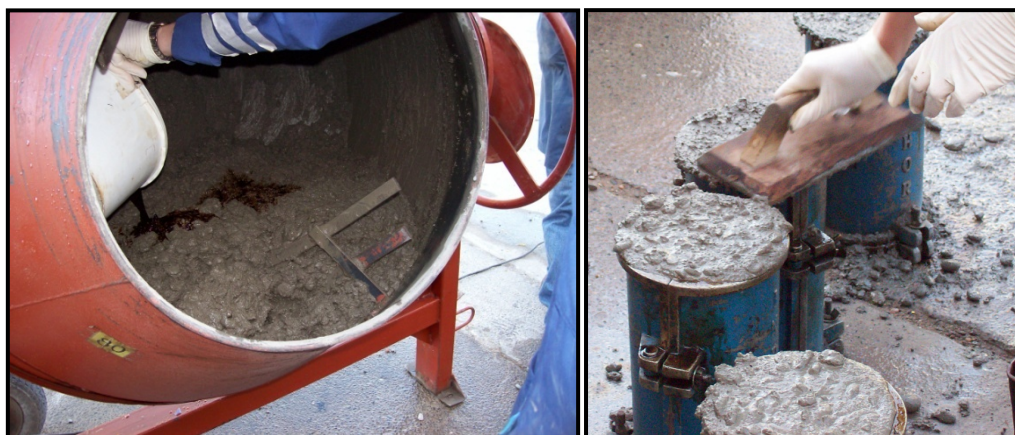
Figura 7. Elaboración de pastones y ejecución de probetas de ensayo en laboratorio.
