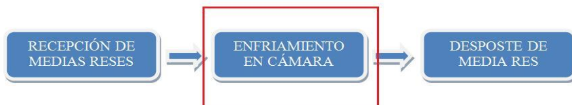
Figura 1: Diagrama del proceso de producción de una planta frigorífica de ciclo II
