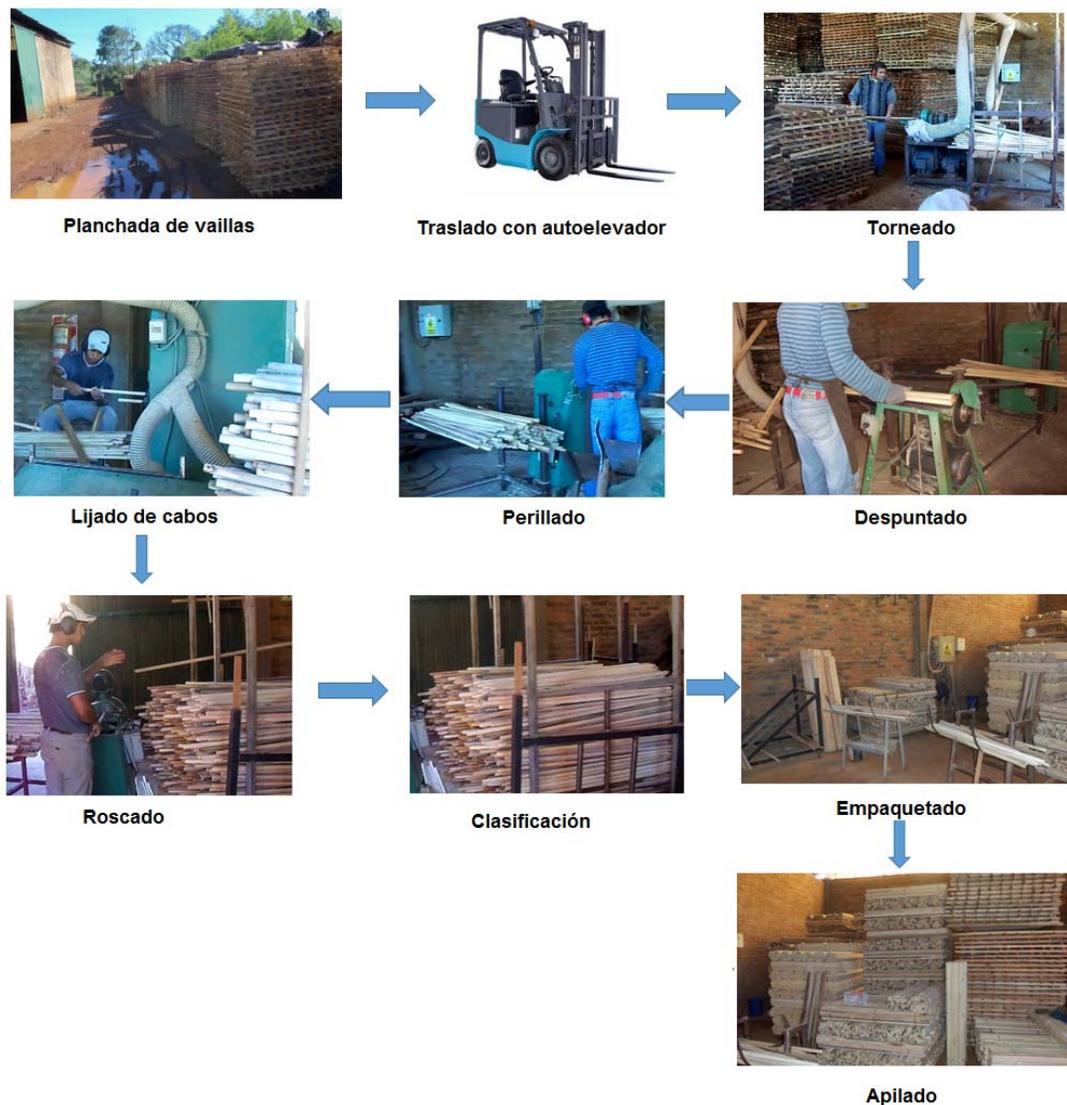
Figura 2. Proceso de producción de cabos en H&H Maderas
