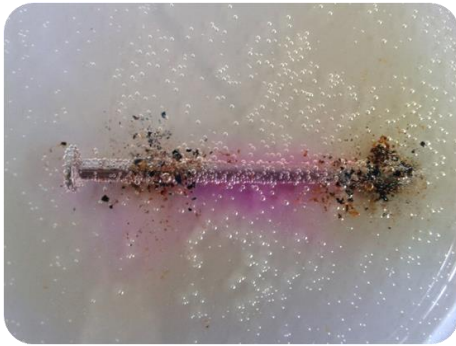
Foto 1. En el clavo sin protección catódica, los indicadores hacen claramente distinguibles las zonas anódicas (coloración marrón) y catódica (coloración rosa).
