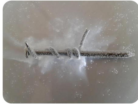
Foto 2. Clavo de hierro con protección, se observa la oxidación del cinc y que el hierro permanece inalterable.
