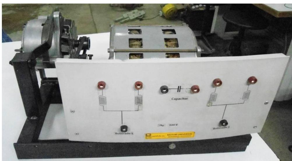
Figura 6 Motor monofásico de jaula de ardilla con alternador
