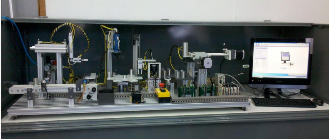
Figura 3 Sistema de Manufactura Integrado por computador
