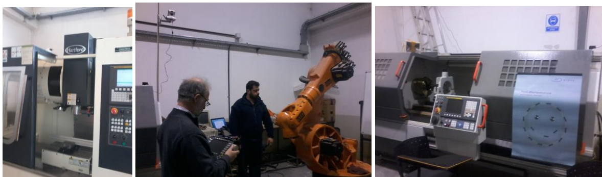
Figura 5. Prácticas robóticas sobre centro de mecanizado CNC, un robot KUKA y torno CNC
