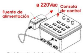
Fig 1-Conexión de la fuente de alimentación
