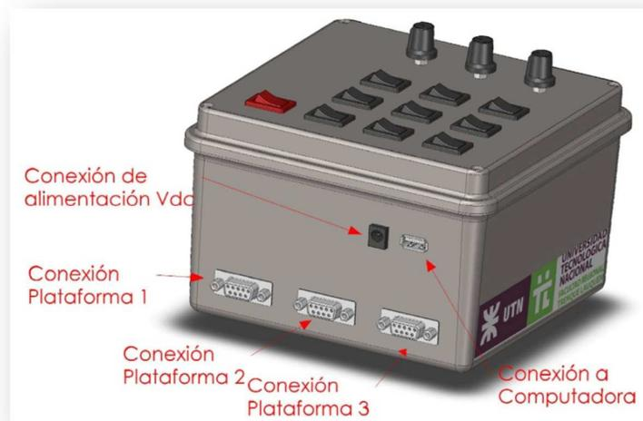
Figura 8 Sistema de control de estímulos-Conectores.
