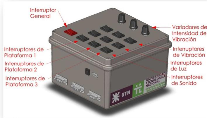
Figura 7 Sistema de control de estímulos-Interruptores y variadores.
