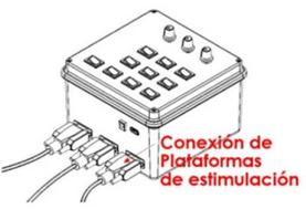
Fig 2-Conexión dispositivos de estimulación
