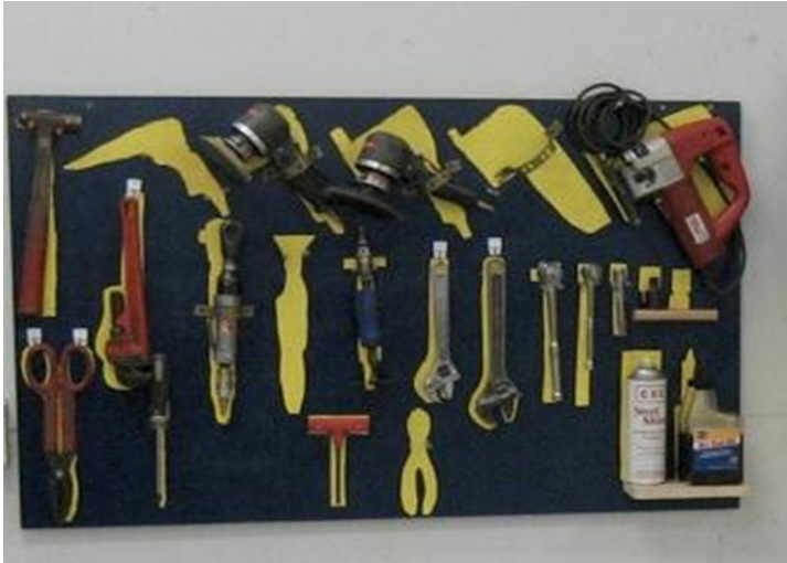
Orden en las herramientas. Fácil visualización de la cantidad total y ubicación de cada una
