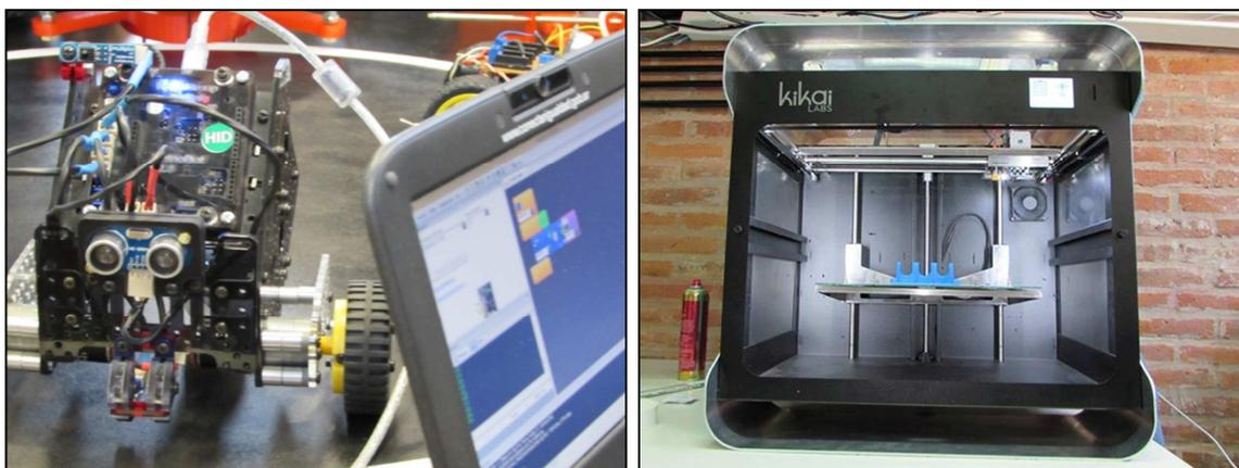
Figura 5 Programación de robot seguidor de línea e impresión en 3D de partes del robot.
