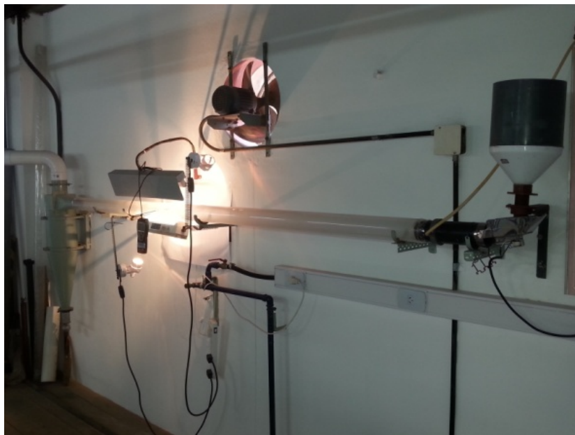
Figura 1 Equipo experimental para la determinación de la velocidad de transporte por saltos.
