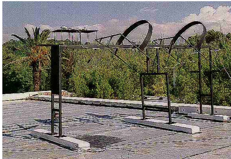
Figura 5.- Estación General para la medición de luz natural ubicada en Mendoza, Argentina, perteneciente a la Red Mundial CIE
