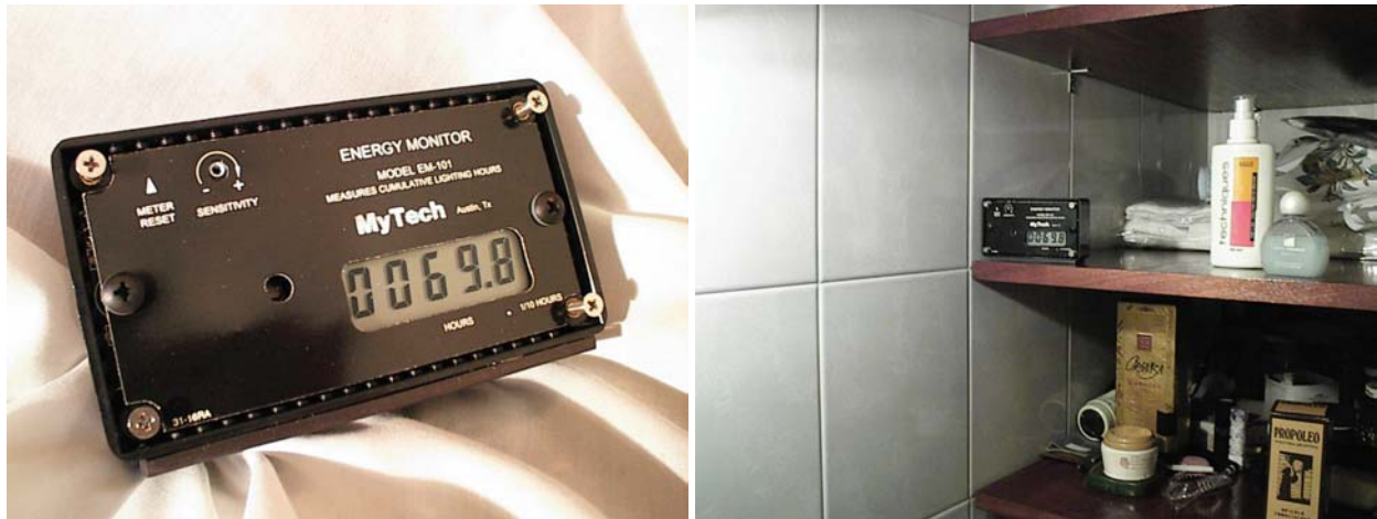
Figura 8. a) Detalle de horómetro lumínico y b) ejemplo de instalación.
