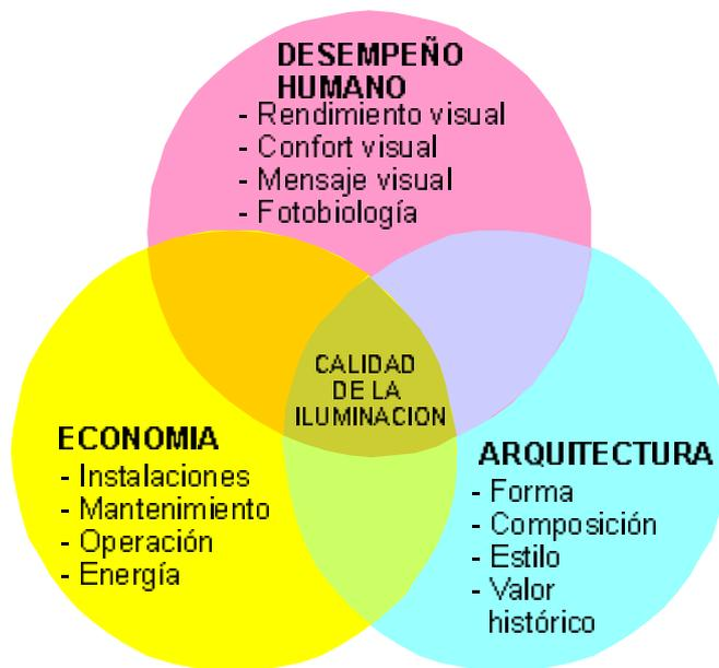
**Figura 2.-** Diagrama de las tres componentes que participan en la definición de calidad de iluminación
