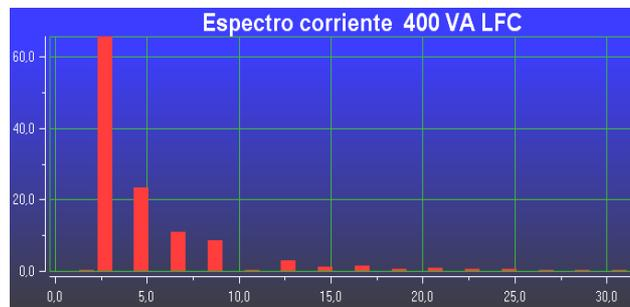
Fig. 7 – Espectro de Corriente para 400 VA con Lámparas de Bajo Consumo.
