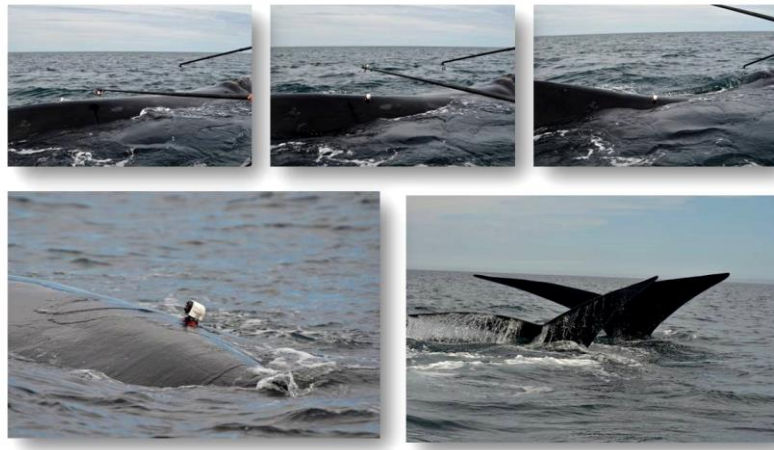
Figura 4. Colocación del dispositivo de adjucción por ventosas. Arriba. Secuencia de la colocación del dispositivo. Abajo izquierda, TDR adherido por las ventosas a la ballena. Abajo derecha, ballenas iniciando la inmersión profunda.
