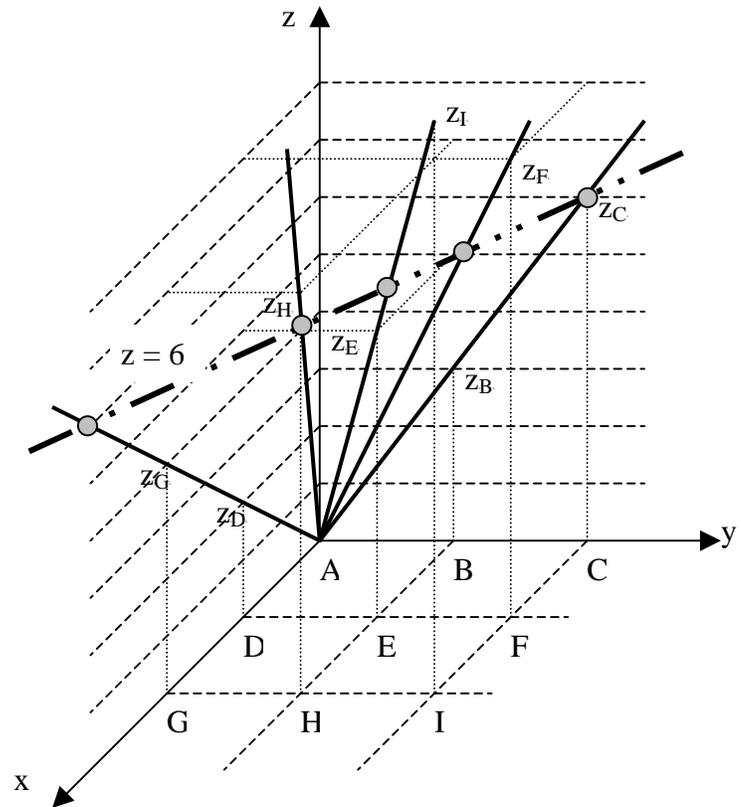
La figura, limitada al primer octante, permite observar la *conicidad* de las directrices de la superficie, aún cuando ésta es, en este caso, un plano inclinado, de extensión infinita, que contiene al origen de coordenadas, como puede verse en la figura siguiente, que muestra las proyecciones sobre el plano  $xy$  de las líneas de nivel correspondientes a distintos valores de  $z$  constante. Las líneas de nivel mencionadas corresponden a distintos valores positivos de la variable  $z$ .
