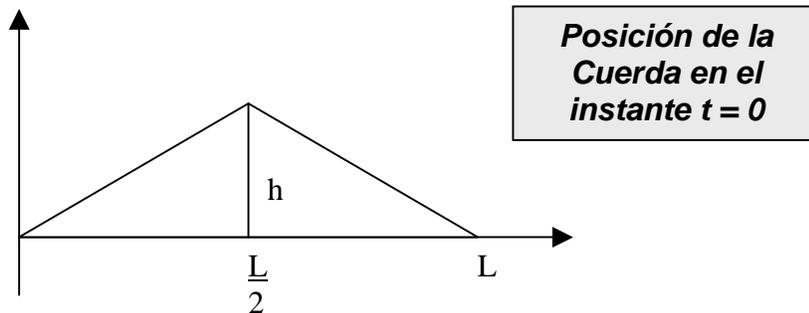
A continuación, descompondremos la función  $y(x, t)$  en un producto de otras dos, una de las cuales depende únicamente de  $x$  y la otra exclusivamente de  $t$ :
