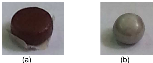
Figura 1: Imágenes de las muestras. (a) M1: Monolito de dispersión homogénea de óxido de hierro en una matriz vítrea de silicato; (b) M2: Monolito de una matriz vítrea de silicato con núcleo de Fe puro.
