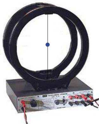
Figura 2a. Ubicación de la muestra en la bobina de Helmholtz
