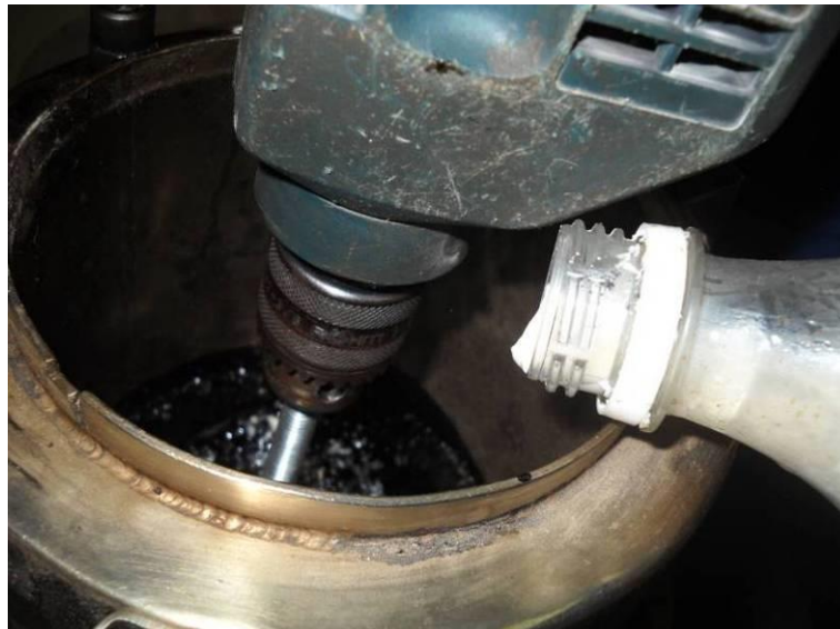
Figura 6. Aditivación de la emulsión de SBR
