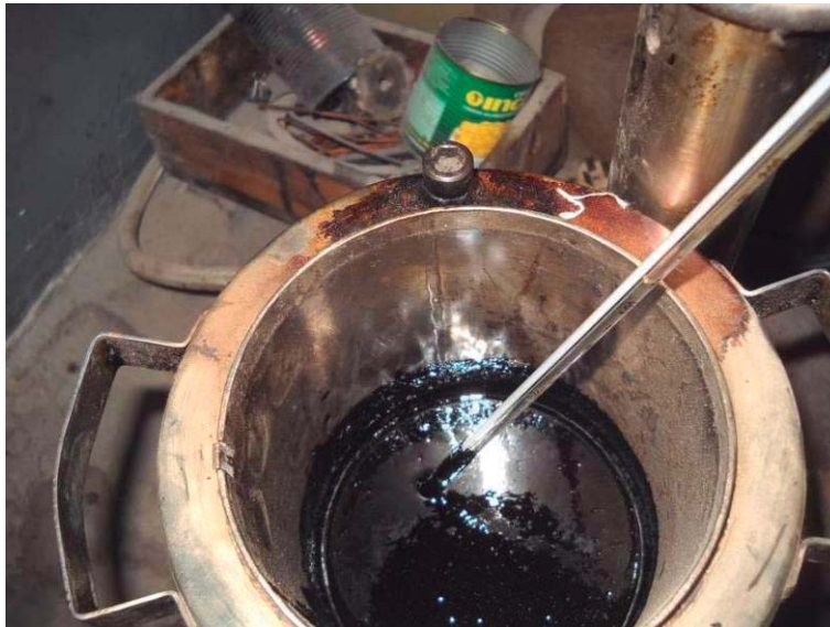
Figura 1. Recipiente termostatzado con muestra de asfalto base
