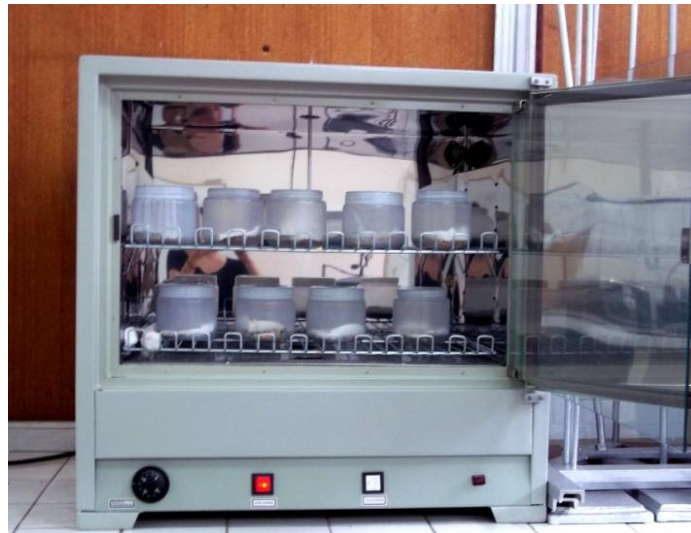
Figura 3. Frascos con las probetas colocados en la cámara de cultivo
