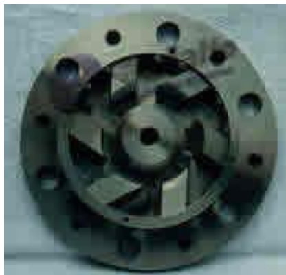
Figura 2. Cabezal con sistema rotor-estator.
