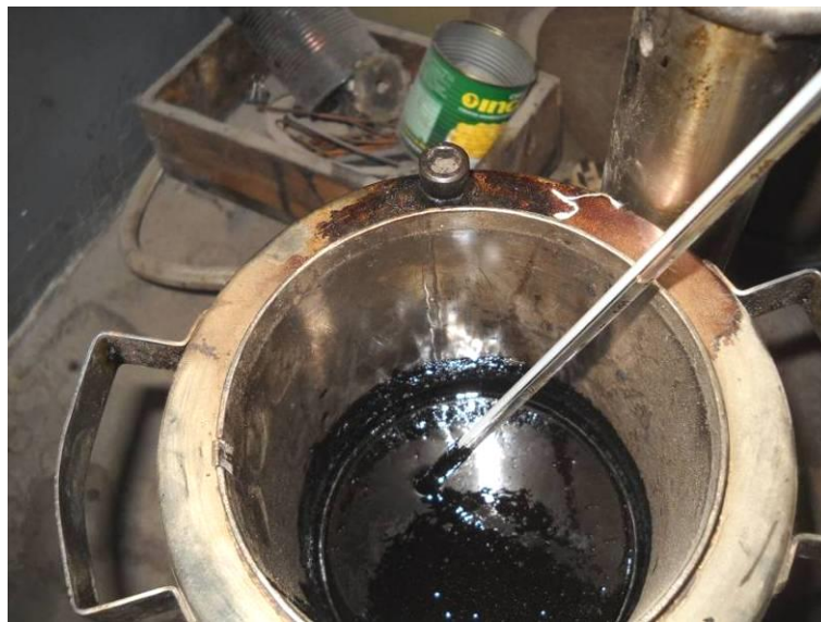
Figura 1. Recipiente termostatzado con muestra de asfalto base
