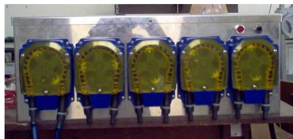
Fig. 1 Panel de bombas peristálticas.
