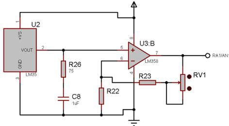
Para poder calibrar el termómetro se colocó un potenciómetro multivoltas que regula la ganancia del amplificador.
