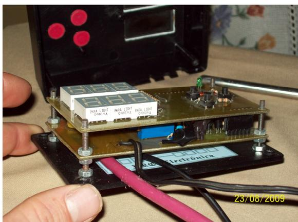
El circuito impreso está hecho sobre una placa de fibra de vidrio, seleccionada por su rigidez y presentación estética. El método para realizarlo fue el de planchado sobre la misma con filmina impresa con el
