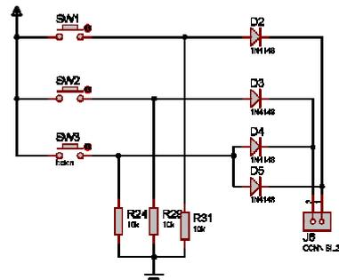
No posee ningún dispositivo antirrebotes de tipo hardware ya que se soluciona desde el software implementado.
