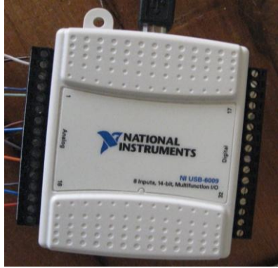
Figura 6. Tarjeta de adquisición de datos USB-6009. Fuente Autores
