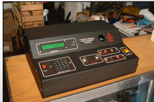
Figura 9. Aspecto físico del Analizador de Módulos de encendido Electrónico.
