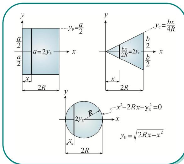
Se hacen rotar las tres figuras alrededor del eje  $x$  generando respectivamente un prisma circular, un cono y una esfera.
