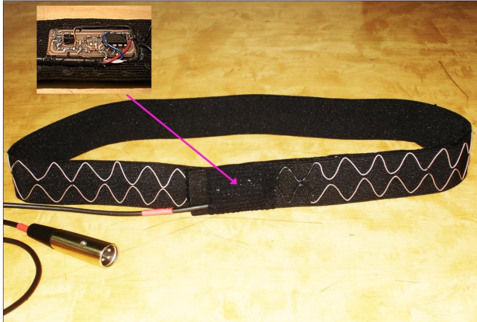
Figura 2. Faja elástica con detalle del circuito electrónico oscilador, FVC y acondicionador.
