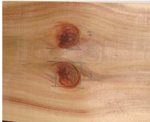
Figura 1: agrupamiento de nudos con desviación de las fibras
