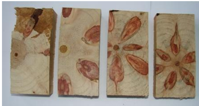
Figura 4 – Fotografía de secciones transversales con agrupamiento de nudos
