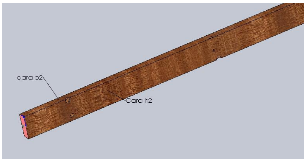
Figura 6 – Vista renderizada de una viga con defectos
