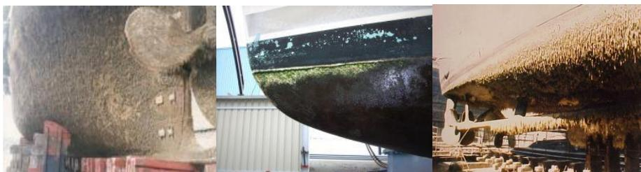
**Figura IV.7. “Biofouling” en carenas de embarcaciones**
