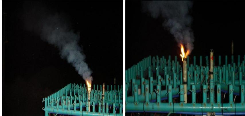
Figura 4 Fotografías de las pruebas de encendido remoto de las bengalas en el prototipo.
