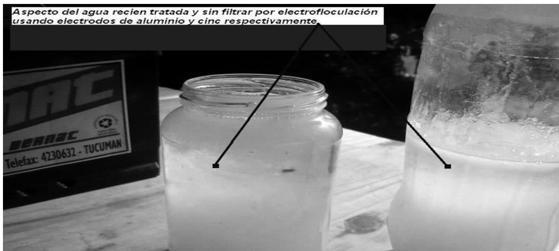
Figura 2 Aguas recientemente electro floculadas con aluminio (izquierda) y cinc (derecha) previo a sedimentar.
