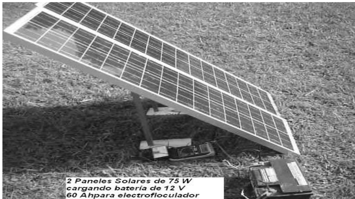
Figura 4. Alternativa de cargar la batería con paneles solares de 75 W en vez de usar un cargador de red.
